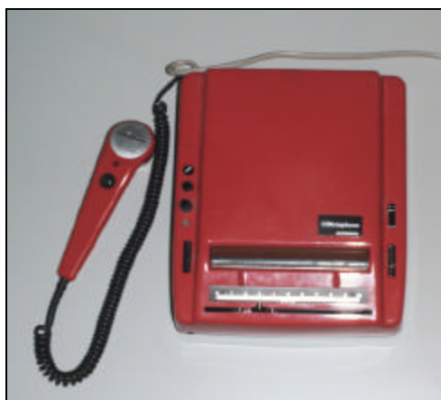
Tonfoliengerät mit 10 Minuten Aufnahmedauer
