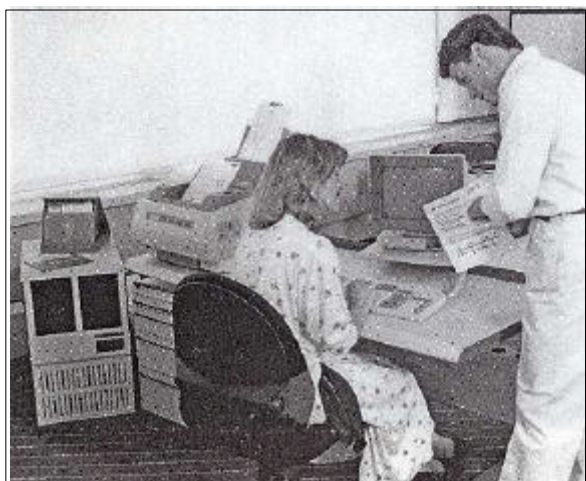
Das AES-System mit Zentraleinheit, Drucker, Bildschirm und 8-Zoll-Programmdiskette
